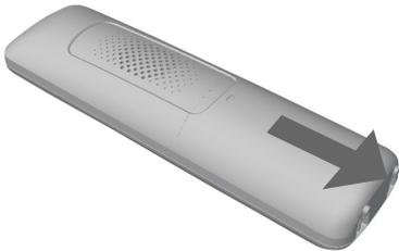
Para reemplazar la batería, presione la lengüeta y deslice hacia abajo la tapa del compartimiento de la batería. Levante la batería antigua y desconéctela del auricular. Siga las instrucciones para instalar y cargar la batería nueva.
